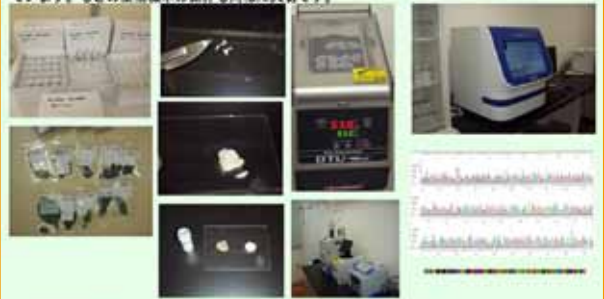
試料収集と保存 → DNA抽出 → PCRによるDNA増幅 → 塩基配列分析
