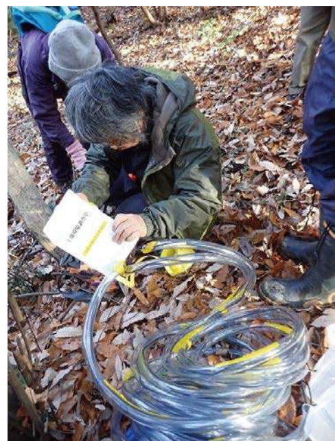
図4. カンアオイ類土壌環境調査の機器設置の様子。土壌湿度、地温の年間の変化を記録する。
